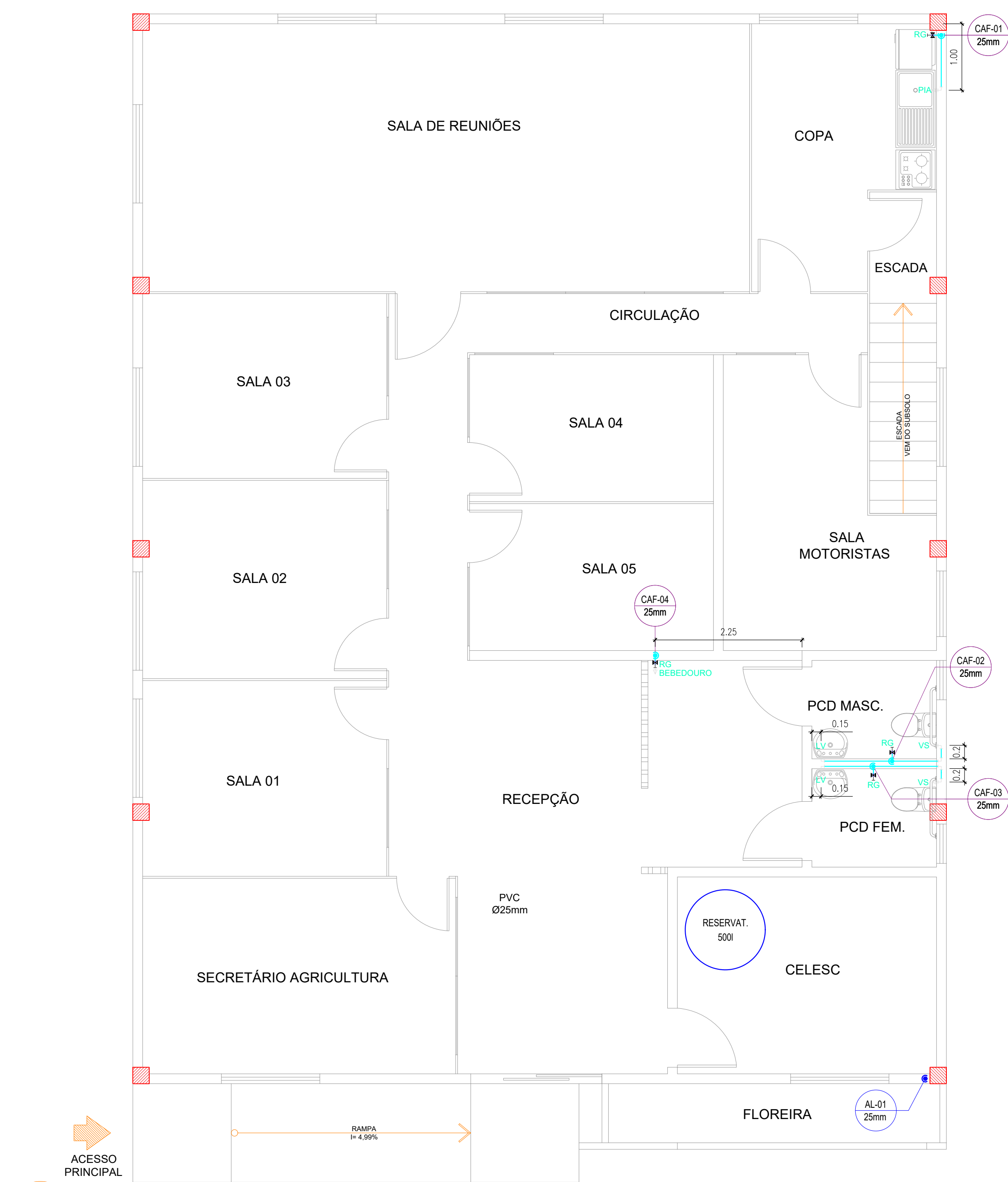
15 INSTALAÇÃO HIDRÁULICA - DISTRIBUIÇÃO ESCALA: 1/50
